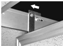
内枠のアームを外枠の切り欠き部に合せて、外枠のストッパーを所定の位置に戻し、取り付けて下さい。
