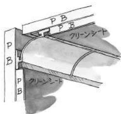
ボードのジョイント部は、目地をとり、裏板ジョイントをコーキング受けにしてコーキング剤を充填して下さい。
