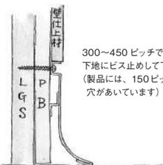
300~450ピッチで下地にビス止めて下さい。(製品には、150ピッチで穴があいています)
