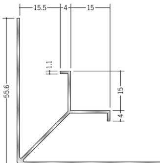
アルミ スパンドレルSK 不燃・SK部材は、「建築用アルミニウム合金材料 焼付け塗装標準仕様書」の仕様に基づいて焼付け塗装を行っています。
