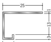
ボード厚と見切縁ののみ込み寸法は0.5mm~1.0mmのクリアランスをとっています。
