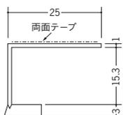
見付け部分が軟質でウラ端を切り欠いているので出隅でも入隅でも自在に曲がります。
