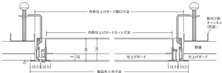
Superリーフ 909vs 吊り金具タイプは、おのずと内枠の重量が重くなりますので、開閉時及び内枠を取り外す際は、十分注意して下さい。
