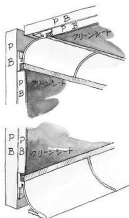
ボーダーのジョイント部は、目地をとり、裏板ジョイントをコーキング受けにしてコーキング剤を充填して下さい。ビスを打った目地部にも、コーキング剤を充填して下さい。
