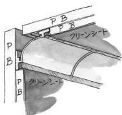
ボーダーのジョイント部は、目地をとり、裏板ジョイントをコーキング受けにしてコーキング剤を充填して下さい。ビスを打った目地部にも、コーキング剤を充填して下さい。
