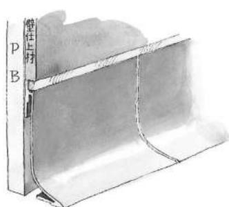
ボードのジョイント部は、目地をとり、裏板ジョイントをコーキング受けにしてコーキング剤を充填して下さい。ビスを打った目地部にも、コーキング剤を充填して下さい。
