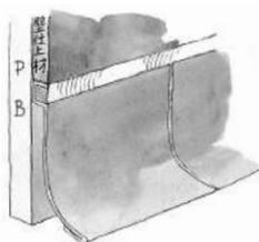
ボードのジョイント部は、目地をとり、裏板ジョイントをコーキング受けにして、コーキングして下さい。ビスを打った目地部にもコーキング剤を充填して下さい。
