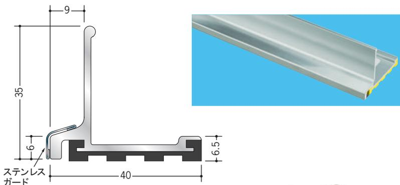
ステンガード部は、ステンレスによるケガを防止する為に、定尺より両端0.5mm程度短くしています。
