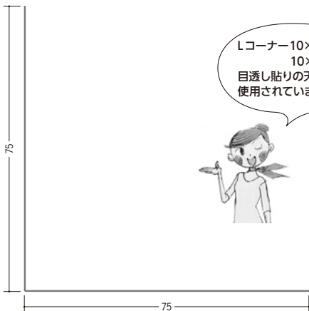
63192 亜鉛折コーナー75 1.82m / アエンメッキ鋼板 t=0.27mm
