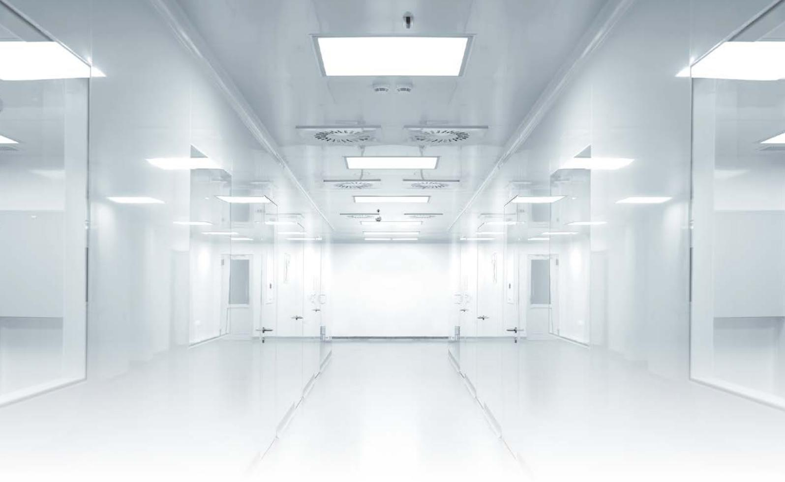
クリーンルームとは空気清浄度が確保された部屋の事でJIS Z 8122ではコンタミネーションコントロール<sup>※1</sup>が行われている限られた空間であって、空気中における浮遊微小粒子、浮遊微生物が限定されて清浄度レベル以下に管理され、また、その空間に供給される材料、薬品、水などについても要求される清浄度が保持され、必要に応じて温度、湿度、圧力などの環境条件についても管理が行われている空間と定義されています。
